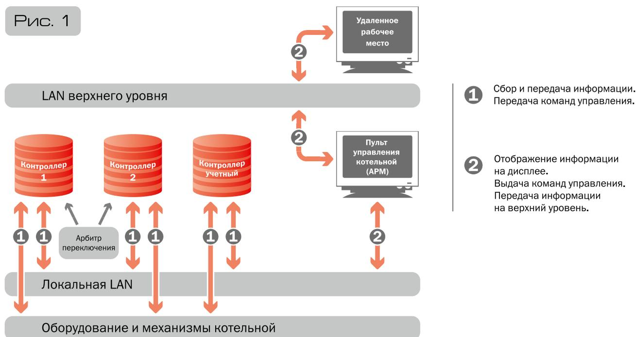
Все оборудование комплекса размещается в шкафу управления размерами 2200x800x600мм, имеющем гибкую иерархическую структуру, и строящемся по многоуровневому принципу в соответствии с требованиями автоматизируемых технологических процессов. Преимущество такой конструктивной схемы аппаратной части: малые габариты, малый вес, облегченный тепловой режим, меньшее количество соединительных кабелей. Все это приводит к повышению надежности работы оборудования.
