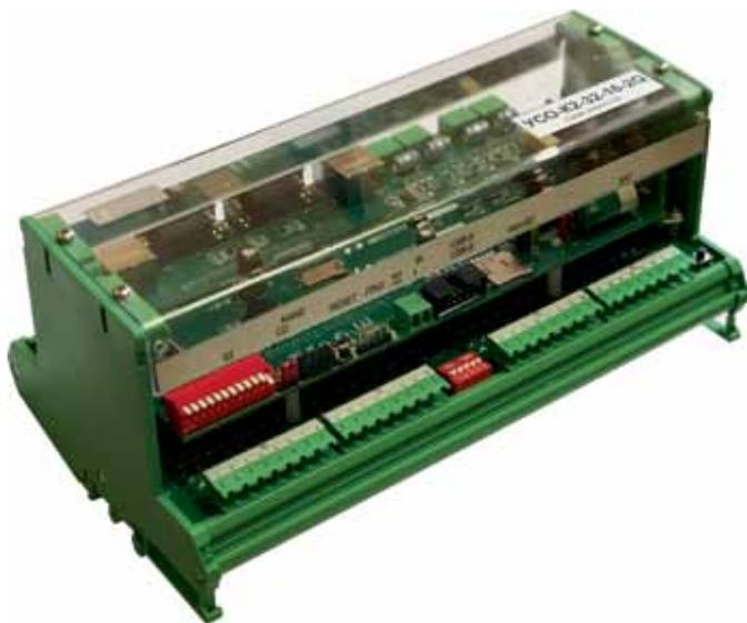
Рис. 4. Промышленный контроллер UCO-K2-32-16-2Q
