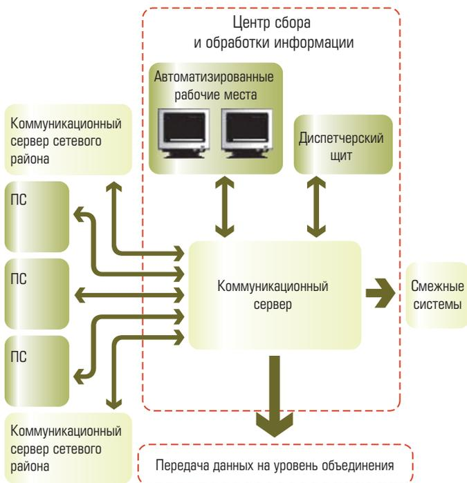
Рис. 3. Структура АСУ ТП на уровне управления
