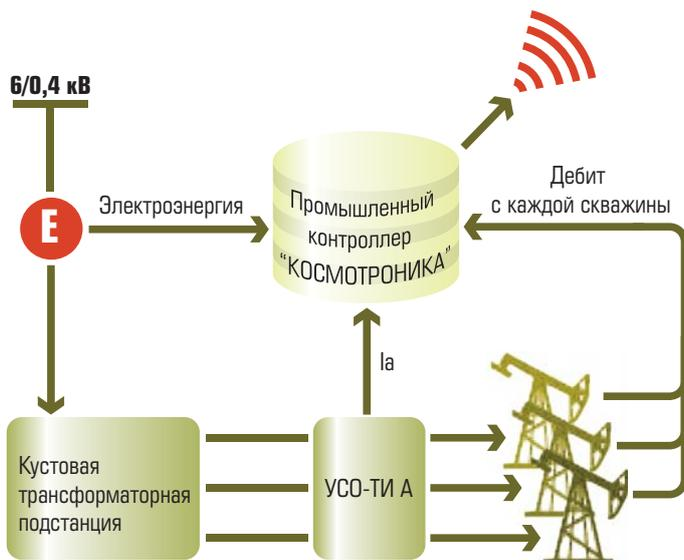
Рис. 4. Применение оборудования ПТК «КОСМОТРОНИКА» на кусте скважин
