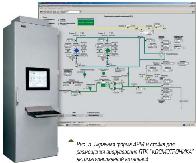
Рис. 5. Экранная форма АРМ и стойка для размещения оборудования ПТК “КОСМОТРОНИКА” автоматизированной котельной
