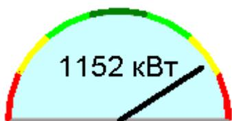
**16.21. MeterTI** – имитирует стрелочный индикатор для заданного телеизмерения. Может быть настроен на один из следующих двух видов:
