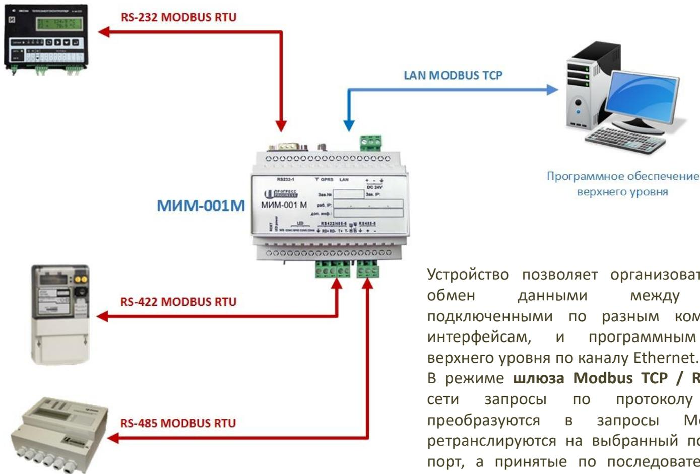
Устройство позволяет организовать двусторонний обмен данными между устройствами, подключенными по разным коммуникационным интерфейсам, и программным обеспечением верхнего уровня по каналу Ethernet.
