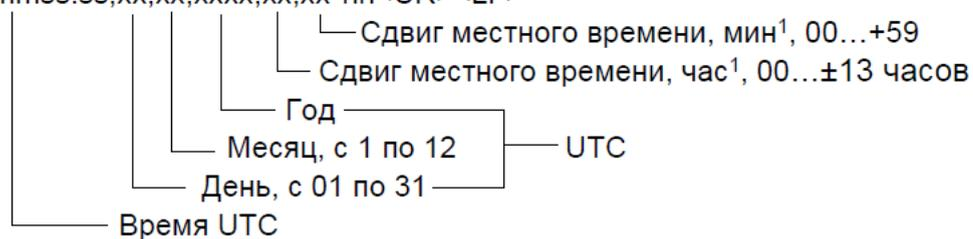
1) Для получения местного времени прибавить к UTC сдвиг местного времени - сумму модуля часов и минут, взятую со знаком сдвига часов местного времени.
