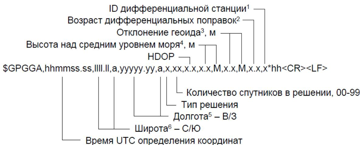
1) ID дифференциальной станции: номер базовой станции дифференциальных поправок. Диапазон значений 0000...4095. В автономном режиме передается пустое поле. При работе по SBAS передается 0000;
